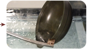
Sản phẩm còn nguyên sau khi thử nghiệm The product is intact after the thermal shock test
